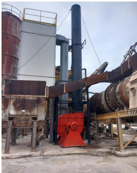
Слика бр. II.19 - Изведен филтерски систем за отпрашување на димни гасови
