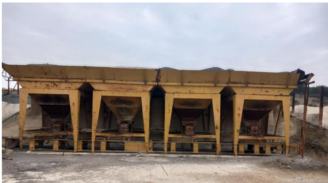
Слика бр. II.5. - Бункери за различни фракции камен материјал (ризла) со димензии од 0-4, 4-8, 8-16 и 16-22 mm. Бункерите се поврзани со транспортна лента за дозирање на ризлата во ротационата сушара
