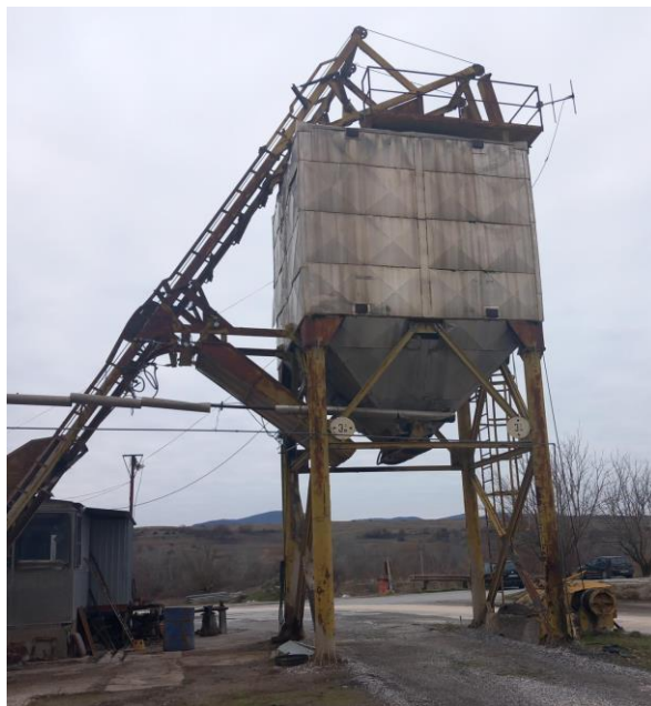
Слика бр. II.17 - Термосилос за готов асфалт со капацитет од 100 t.
