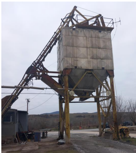
Слика бр. 8. - Термосилос за готов асфалт со капацитет од 100 t. Термосилосот се загрева преку греен медиум терманол
