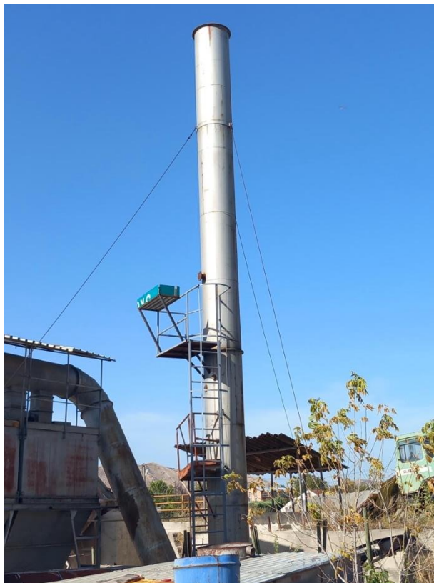
Слика II.19. Емитер (оџак) со висина од 14 и дијаметар од 0,8 m за одведување на димните гасови од ротационата сушара со пристапна платформа за поставување на мерна опрема за мерење на емисиите.
